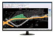
工事に必要な測量計算、CAD、出来形・写真・品質管理、電子納品などをパッケージした土木施工業向けオールインワンシステムです。
